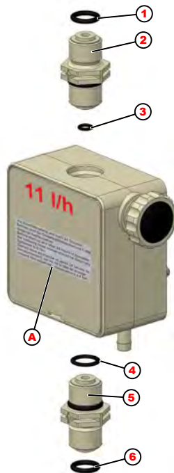
Fig. 19 : Remplacement des soupapes d'aspiration / de refoulement et de la cartouche de dosage
